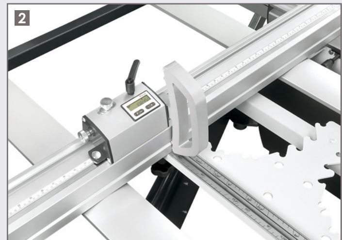
Digitale uitlezing met micrometrische fijnregeling op de beide flippers
