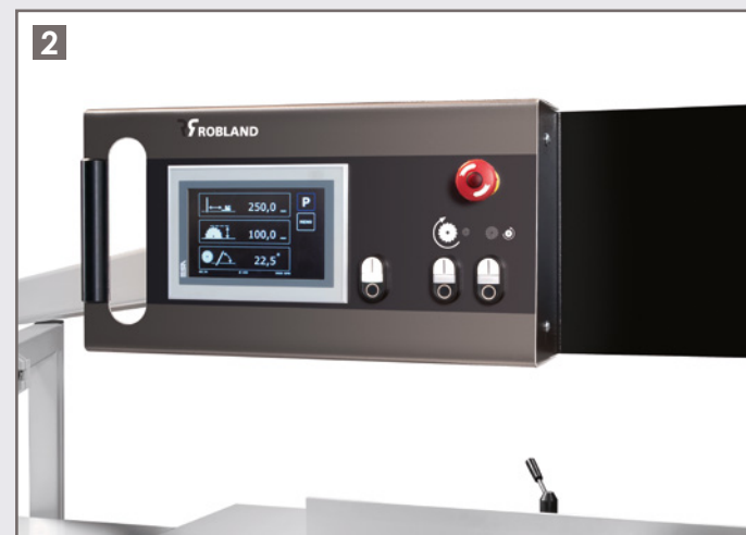
Een bedieningspaneel met 7" touch screen op ooghoogte voor het sturen van 3 assen
