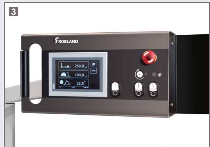
3-assen sturing via touch screen op ooghoogte
