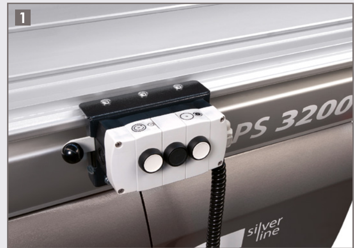
Mobiele bediening zaag en voorrits op de rolwagen
