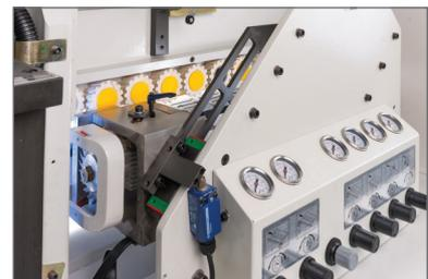
Für Fasen und Rundungen steht ein **Feinfräsaggregat** zur Verfügung. Die Feineinstellungen können manuell über digitale Anzeigen festgelegt werden. Eine Absaugung verhindert Spanschläge.
