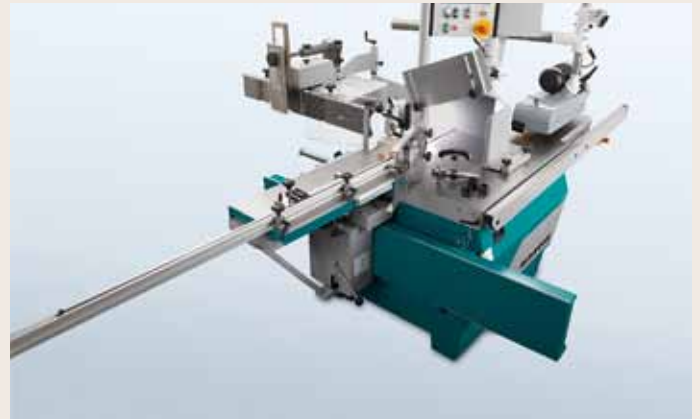
Schiebetisch für Schlitzarbeiten gerüstet
